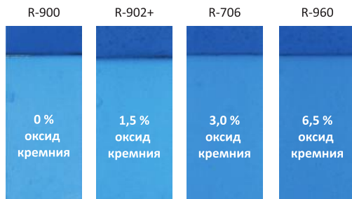
Рис. 6. Выцветание на панелях после 12 месяцев экспозиции во Флориде. Самые верхние части панелей были защищены от УФ-излучения и демонстрируют первоначальный цвет пленки.
