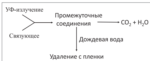
Рис. 1. Деструкция лакокрасочных пленок в результате поглощения УФ-излучения
